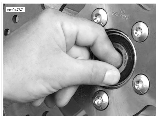
Figure 1-6. Inspecter les roulements de roue
